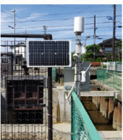
排水路 水位・雨量計測(7箇所)
